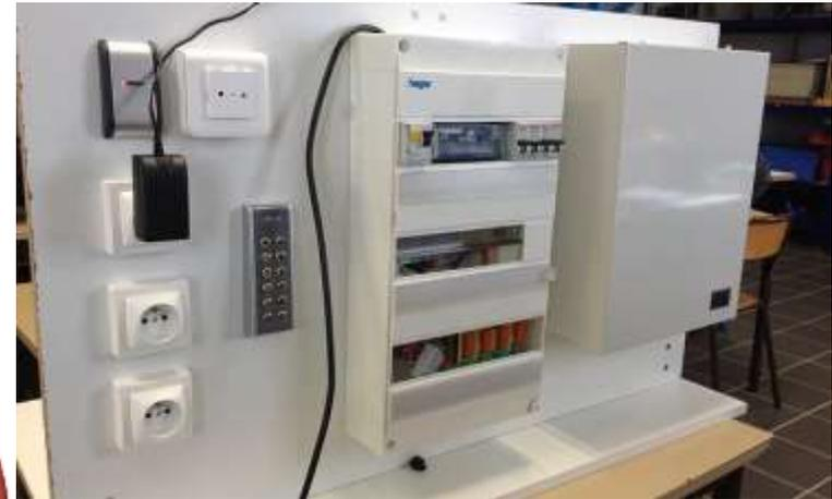
**Etape 1 :** *Etude de l'éclairage, des volets roulants* : pouvoir gérer les luminaires et les volets roulants par le biais du système "Varuna". Notamment grâce à des détecteurs (crépusculaire et de mouvement) ou par des scénarios d'usages ou programmés sur tablette tactile. Cela va permettre un confort d'utilisation et des économies d'énergie.
