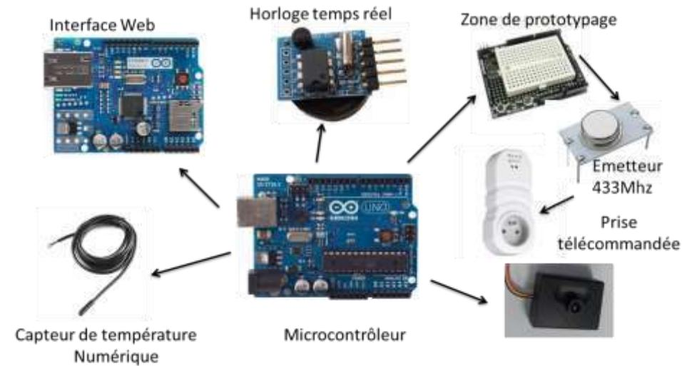
**Etape 3 : Assemblage des composants:** interface web, horloge en temps réels, zone de prototypage, émetteur 433 Mhz, prise de télécommande, microcontrôleur, capteur de température Numérique
